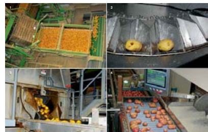
Dans les structures de conditionnement, les tubercules sont lavés et séchés, un échantillon est analysé pour fixer la qualité du lot. Les tubercules sont lavés, puis triés optiquement avant d'être conditionnés et prêts pour la livraison
